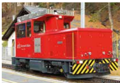
Eine Lok für viele Fälle: Die erste von Stadler gebaute Zahnrad-Adhäsion Diesellokomotive HGm 2/2 für ein Schweizer Bahnunternehmen.
